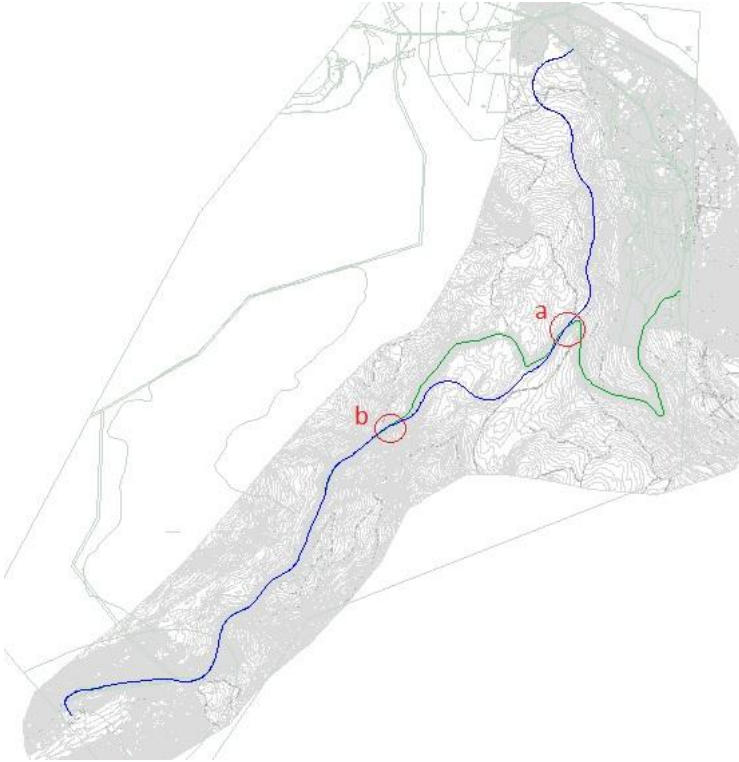
Figur 16 Tilkoplingspunkt mellom ny og eksisterande trasé
